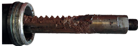
Crémaillère endommagée par la corrosion
